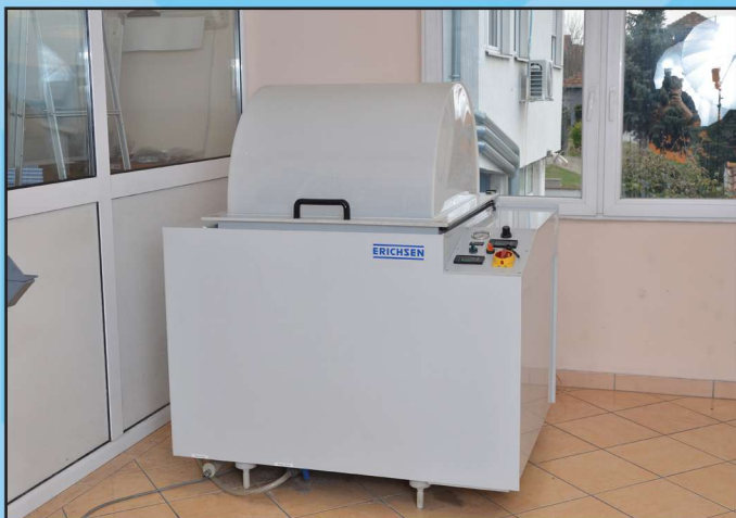
Uredjaj za ispitivanje korozijske postojnosti
