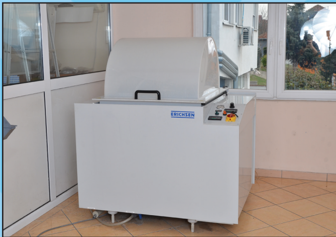
Uredjaj za ispitivanje korozijske postojnosti
